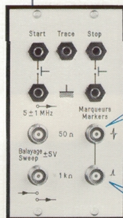
Marqueurs type «papillon» compatibles avec les vitesses de balayage des oscilloscopes.
